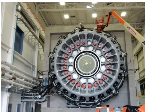
Generador síncrono de imanes permanentes para un aerogenerador. Engineering.com
